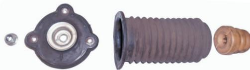
**5** Substitua o amortecedor, não esquecendo de efetuar o escorvamento. Verifique também os demais componentes da suspensão dianteira. Se apresentarem desgastes, substitua-os. Dessa forma todo o conjunto trabalhará na mesma condição.
