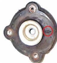
**4** Na bancada, coloque o encolhedor de molas e remova a porca, o coxim, a coifa, o batente e a mola helicoidal.
