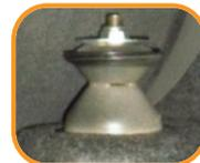
**4** Substitua o amortecedor, não esquecendo de efetuar o escorvamento e monte todas as peças do conjunto na bancada, acompanhando a sequência correta dos componentes e, em seguida, monte o conjunto no veículo.
