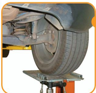
**1** Levante o veículo e, para aliviar a tensão dos parafusos e dar suporte, apoie a roda com macaco hidráulico ou utilize um cavalete no eixo. Logo após, solte a porca de fixação inferior do amortecedor, porém não retire o parafuso ainda.
