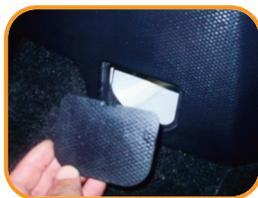
**1** Com o veículo no solo, será necessário soltar as porcas do coxim. Para acessá-las, remova as duas tampas da guarnição lateral.
