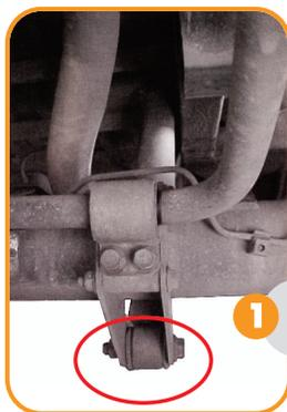
1 Com o veículo suspenso, remova o parafuso de fixação inferior do amortecedor.
