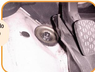
2 Remova a porca superior do amortecedor e suspenda o veículo.
