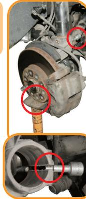
**4** Remova o parafuso da manga de eixo e coloque a ferramenta de abertura da manga de eixo. Retire o cavalete por um instante e, solte o conjunto amortecedor da manga de eixo. Logo após, recoloca o cavalete no disco.
