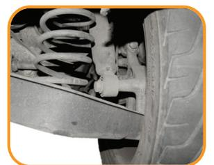
**4** O aperto do parafuso inferior do amortecedor traseiro deve ser feito utilizando um torquímetro, ajustado de acordo com as especificações da montadora, e com o veículo no solo, para evitar danos à bucha do amortecedor.
