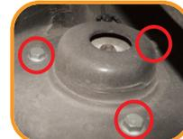
**5** Solte os três parafusos superiores do coxim do amortecedor, retire o conjunto prenda-o na morsa.
