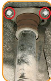
**2** Solte os parafusos de fixação superior do amortecedor. Remova-o e prenda-o na morsa.
