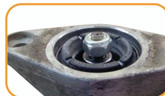
4 Substitua o amortecedor, não esquecendo de efetuar o escorvamento e monte todas as peças do conjunto na bancada, acompanhando a sequência correta dos componentes e, em seguida, monte o conjunto no veículo.
