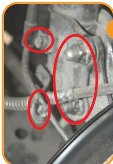
1 Com o veículo no solo, remova o parafuso do flexível, os parafusos da manga e o suporte ABS.
