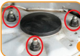
3 E solte os parafusos de fixação superior.
