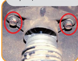
3 Retire o amortecedor e prenda-o na morsa. Na bancada, remova a porca de fixação superior do amortecedor, o espaçador, o batente a coifa.
