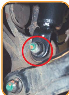
1 Com o veículo no solo, afrouxe os parafusos das rodas, levante o veículo e retire as rodas. Logo após, apoie o eixo com cavaletes para aliviar a tensão no amortecedor e retire o parafuso de fixação inferior do amortecedor
