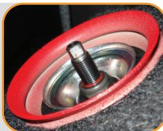
**3** Após essas operações, leve o conjunto amortecedor e mola para a bancada e remova na ordem: mola, calço, coxim do amortecedor, arruela de encosto, batente e coifa do amortecedor.
