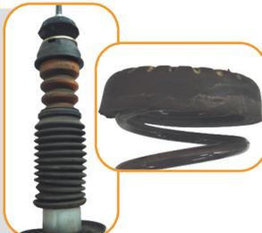
**2** Com o veículo suspenso, apoie o macaco no eixo, retire a porca da haste e apenas alivie a carga do parafuso inferior do amortecedor. Desça o eixo com o macaco, até aliviar a carga da mola. Em seguida, retire o parafuso e o amortecedor.
