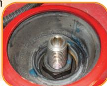
**3** Com o veículo suspenso, remova a bieleta e a cinta de apoio. Logo após, remova também o parafuso da manga de eixo e introduza o expensor da manga. Somente após essas operações, retire o montante completo e o leve para bancada.
